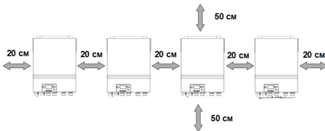
**ПРИМЕЧАНИЕ.** С целью отвода тепла и для обеспечения соответствующей циркуляции воздуха, зазор с боковых сторон блока должен быть приблизительно 20 см, а сверху и снизу блока — приблизительно 50 см. Все блоки должны быть расположены на одной высоте.
