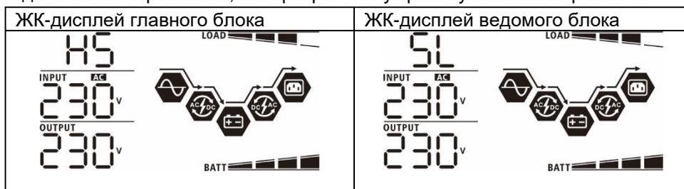
Шаг 5. Если оповещения о неисправностях больше не появляются, установка параллельной системы полностью завершена.
