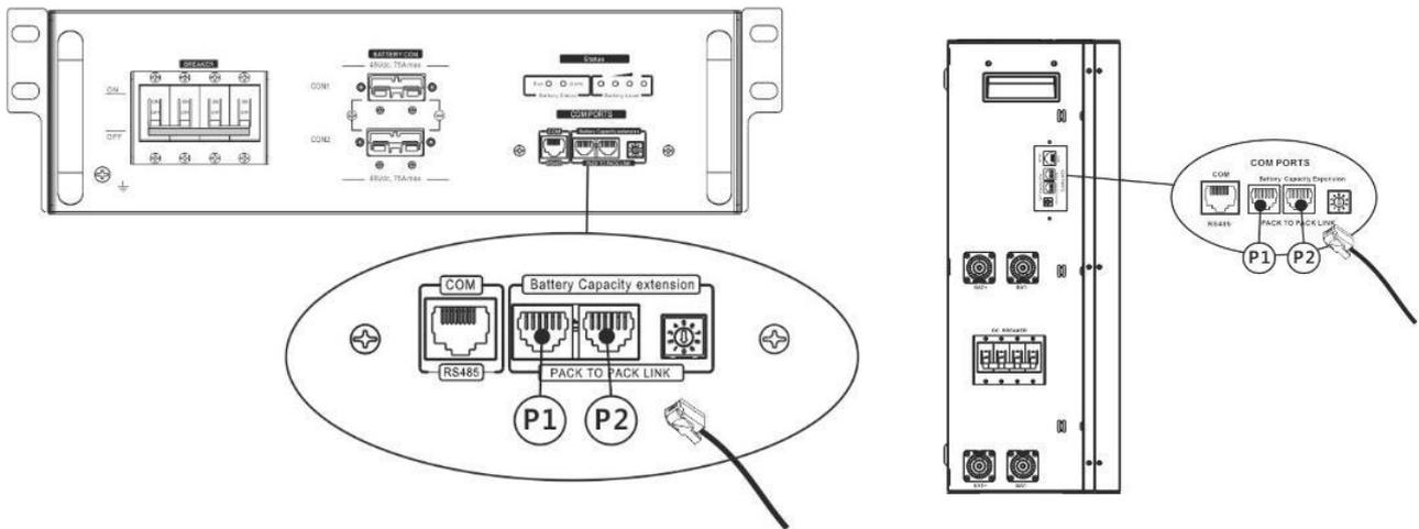
Шаг 2. Воспользуйтесь кабелем RJ45 для соединения инвертора и литиевой батареи (входит в комплект поставки модуля батарей).
