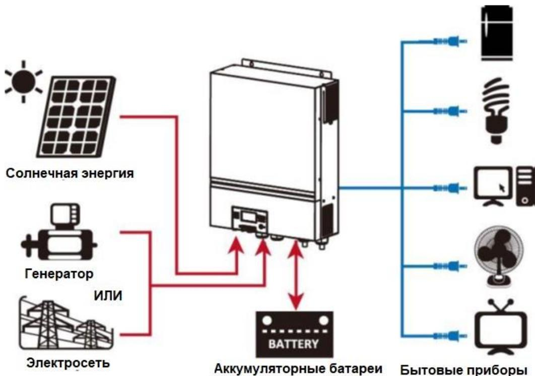
Рисунок 1 Общая структурная схема гибридной фотоэлектрической системы.
