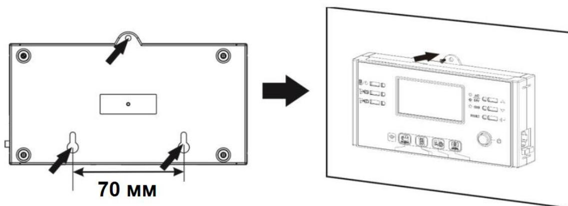
**Примечание.** Монтаж панели следует выполнять, используя соответствующие винты, представленные на рисунке справа.
