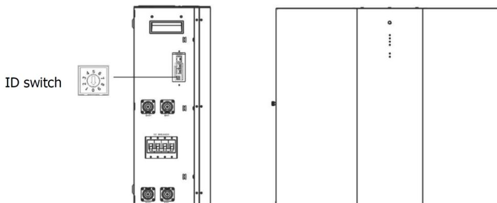
Идентификационный переключатель обозначает уникальный идентификационный код для каждого модуля батарей. Это требуется для определения уникального идентификационного номера для каждого модуля батарей для штатного режима эксплуатации.
