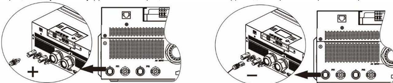
При подключении фотоэлектрических модулей для безопасной и эффективной работы солнечной электростанции большое значение имеет выбор кабеля соответствующего сечения. Для уменьшения риска травм, пожалуйста, используйте кабель рекомендованного сечения, указанного в таблице ниже.
