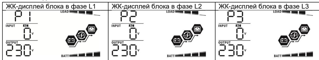
Шаг 4. Включите все автоматические выключатели переменного тока в фазных проводах на входе переменного тока. Если соединение переменного тока будет обнаружено и три фазы соответствуют настройкам блока, система начнет работу в штатном режиме. В противном случае начнет мигать значок и блоки не будут функционировать в линейном режиме работы.
