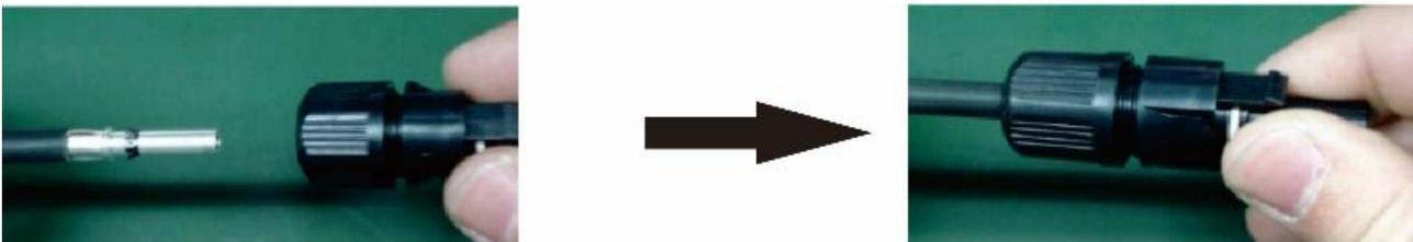
Вставьте часть кабеля без изоляции в штыревую клемму и обожмите штыревую клемму:
