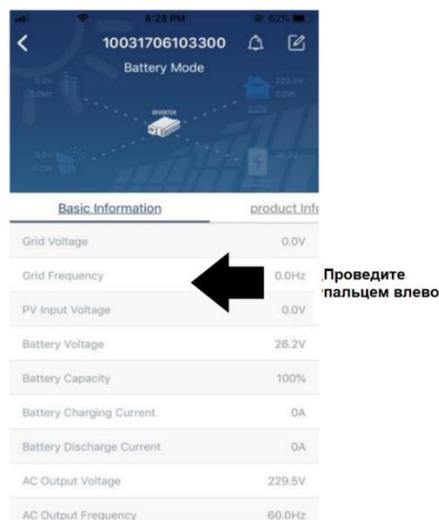
**[Basic Information] (Основная информация)** отображает основную информацию об инверторе, включая такие параметры как напряжение переменного тока, частота переменного тока, напряжение на входе фотоэлектрических модулей, напряжение батареи, емкость батареи, ток заряда, напряжение на выходе, частота на выходе, полная мощность на выходе, активная мощность на выходе и процент нагрузки. Прокрутите список вверх, чтобы увидеть дополнительную основную информацию.
