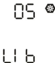
Если связь между инверторами и батареей успешно установлена, на ЖК-дисплее загорится значок
