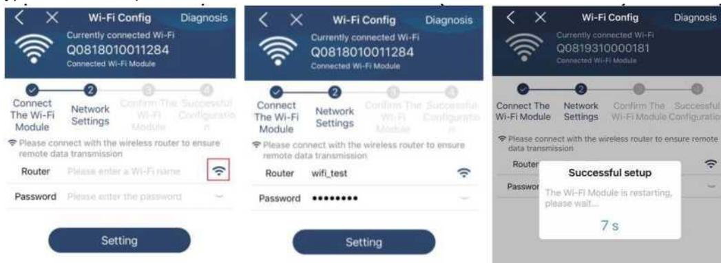
Шаг 4. Коснитесь кнопки «Confirm» (Подтвердить) для завершения настройки Wi-Fi между модулем Wi-Fi и Интернетом.
