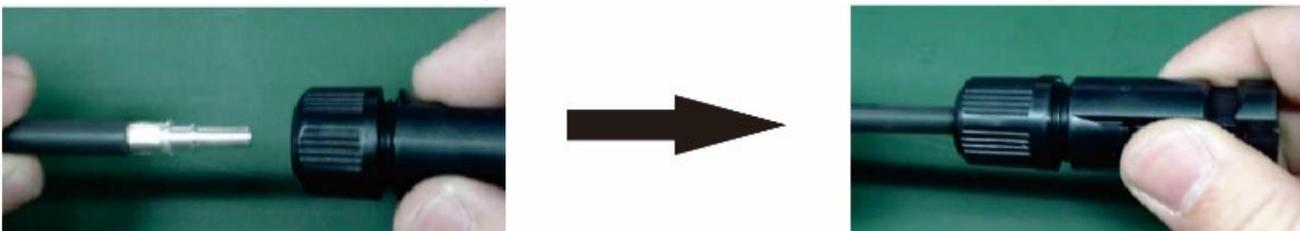
С помощью ключа надежно наверните прижимной колпачок на гнездовой и штыревой разъемы:
