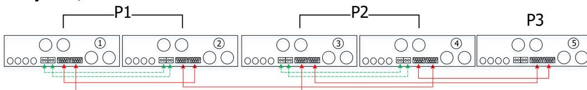
Два инвертора для одной фазы и по одному инвертору для остальных двух фаз
