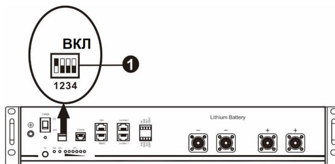
① Двухпозиционный переключатель. Имеется 4 двухпозиционных переключателя, задающие различную скорость передачи данных и адреса групп батарей. Положение микропереключателя «OFF» [выключено] соответствует значению «0». Положение микропереключателя «ON» [включено] соответствует значению «1».
