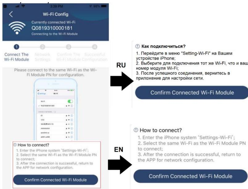
Войдите в «Settings→Wi-Fi» (Настройки→Wi-Fi) и выберите имя подключаемого Wi-Fi-модуля. Имя Wi-Fi то же, что и ваш номер модуля Wi-Fi. Также введите пароль по умолчанию «12345678».
