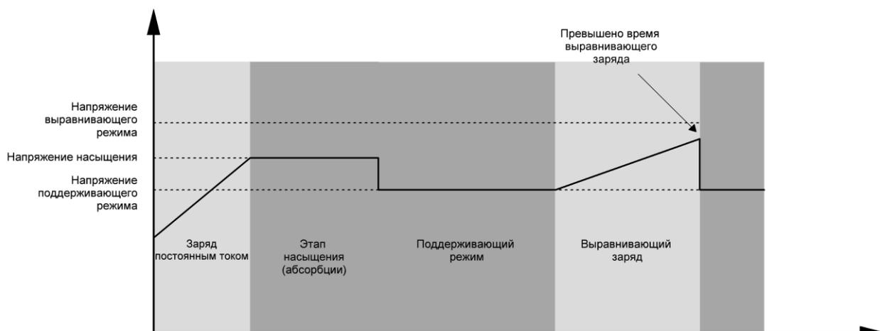
Однако, если по истечении времени выравнивающего заряда напряжение батареи не поднимется до напряжения выравнивающего заряда, контроллер продлевает время до тех пор, пока не напряжение батареи не достигнет напряжения выравнивающего заряда. Если напряжение батареи остается ниже напряжения выравнивающего заряда к моменту, когда будет превышено заданное время, контроллер заряда прекращает выравнивающий заряд и возвращается к поддерживающему режиму.
